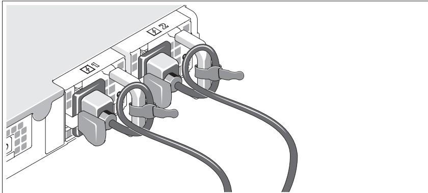
Branchez le(s) câble(s) d'alimentation sur le système (l'illustration présente un système redondant). Pour les systèmes redondants, attachez les câbles à l'aide des deux bandes Velcro fournies avec le système, comme indiqué dans l'illustration. Pour les systèmes non redondants, installez le support de fixation de câble d'alimentation fourni avec le système.
