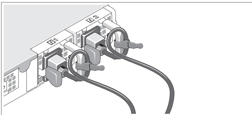
Conecte os cabos de energia ao sistema (veja na ilustração um exemplo de sistema redundante). No caso dos sistemas redundantes, prenda os cabos com as fitas de velcro incluídas na remessa, conforme mostrado. Nos sistemas não redundantes, use o suporte de retenção do cabo de alimentação enviado com o sistema.
