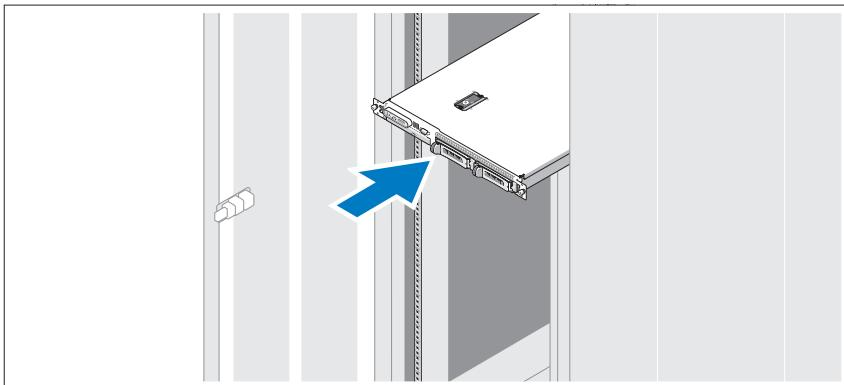
Después de leer las instrucciones de seguridad incluidas en la documentación del sistema relativa a la instalación del rack, instale el sistema en el rack.
